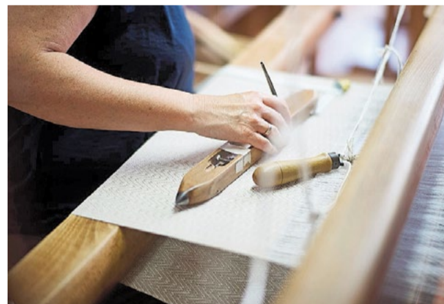
An einem Arbeitstag werden die Schiffchen mit Schnellschuss bis zu 30 000 Mal von Hand hin und her geschleudert.
